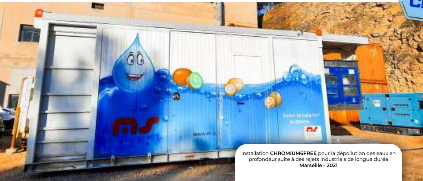
Installation **CHROMIUM6FREE** pour la dépollution des eaux en profondeur suite à des rejets industriels de longue durée
