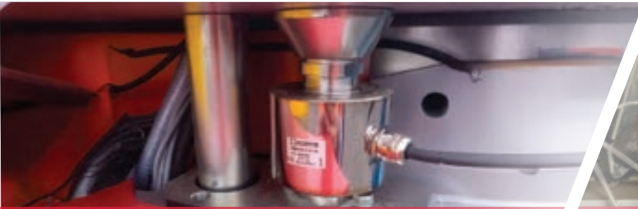
01 Capteurs de pesage pour maîtriser les cycles de débâtissage et le calcul de la siccité en ligne
